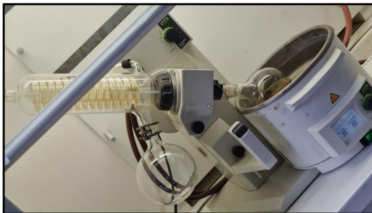
Figure 12 : Évaporateur rotatif (Rotavap) utilisé pour l'évaporation de l'extrait végétal
