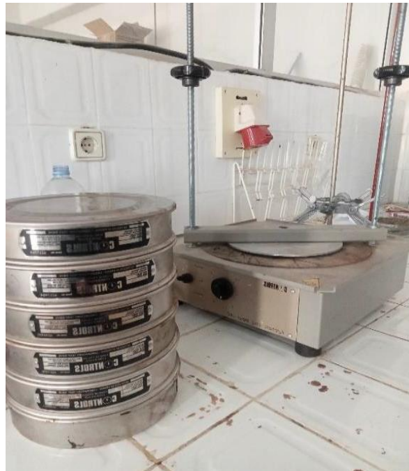
Figure III.6 : Les échantillons et la pile de tamis de laboratoire
