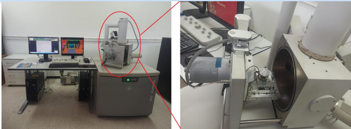
Figure III.11 : Appareil de MEB-EDX (Laboratoire d'ENSTI, Annaba) (5)
