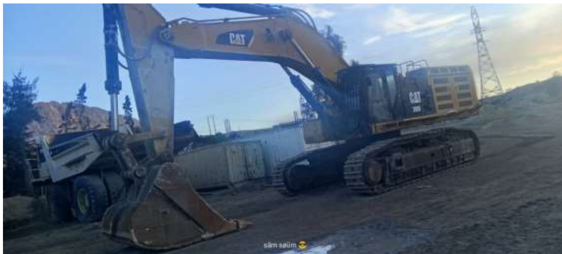
Figure.I.12 : pelle Cat 390F utilisée pour le chargement
