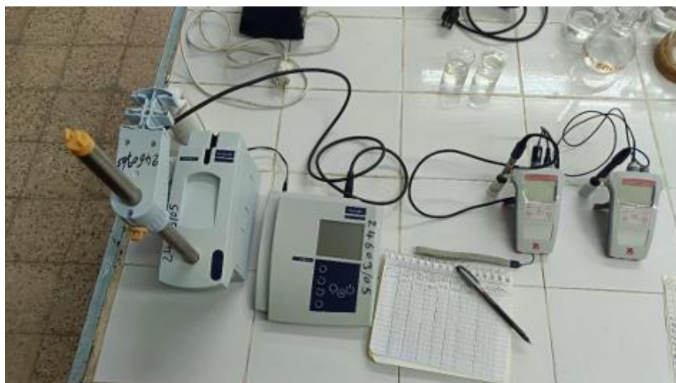
Figure 30 : Appareil de mesure de Conductivité, Salinité, TDS au laboratoire.
