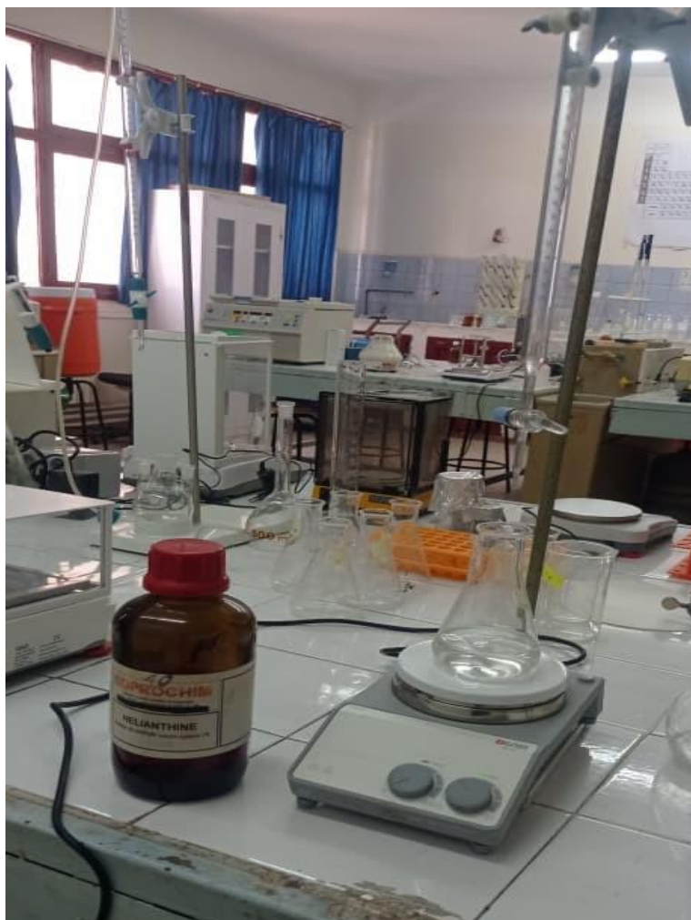
Figure 31 : Dispositif expérimental pour le dosage de l'Alcalinité (TAC) par Titrimétrie.
