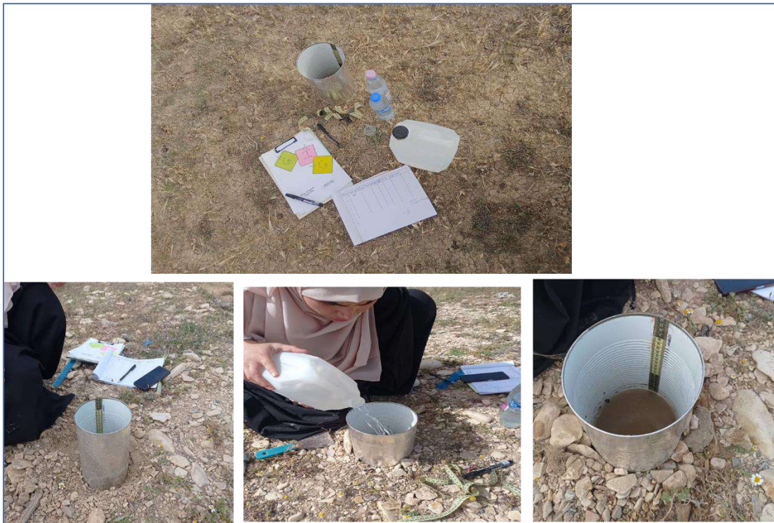
Figure 71 : Matériel utilisé pour l'essai d'infiltration (méthode du monocylindre)
