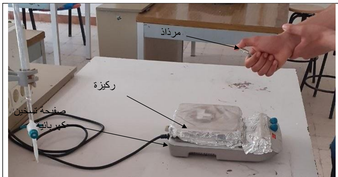
الشكل 1.2: عناصر التركيب المكونة لتقنية الرش مع الانحلال الحراري
