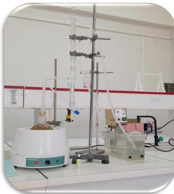
Figure 16: hydro-distillateur de type clevenger (photo personnelle)
