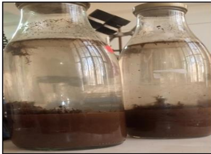
Figure. 35 : la granulométrie par le test de bouteilles (photo personnelle, février 2024)
