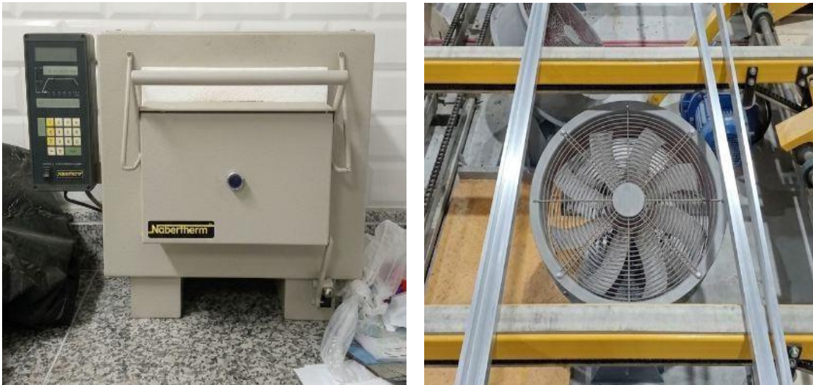
Figure III. 4 : Four de vieillissement artificiel et la méthode de refroidissement (à l'aire).
