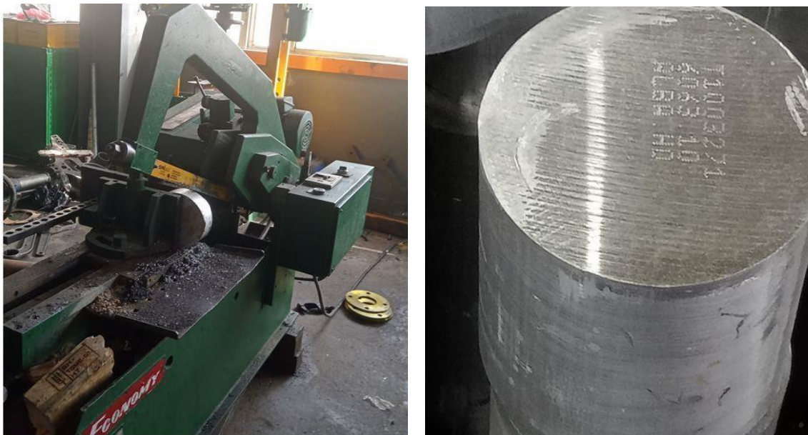
Figure III. 5 : Machine de tronçonnage et un billet d'alliage étudié.
