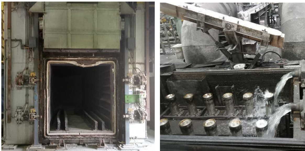
Figure III. 3 : Four utilisé dans le traitement thermique d'homogénéisation et la méthode de refroidissement (trempe à l'eau).
