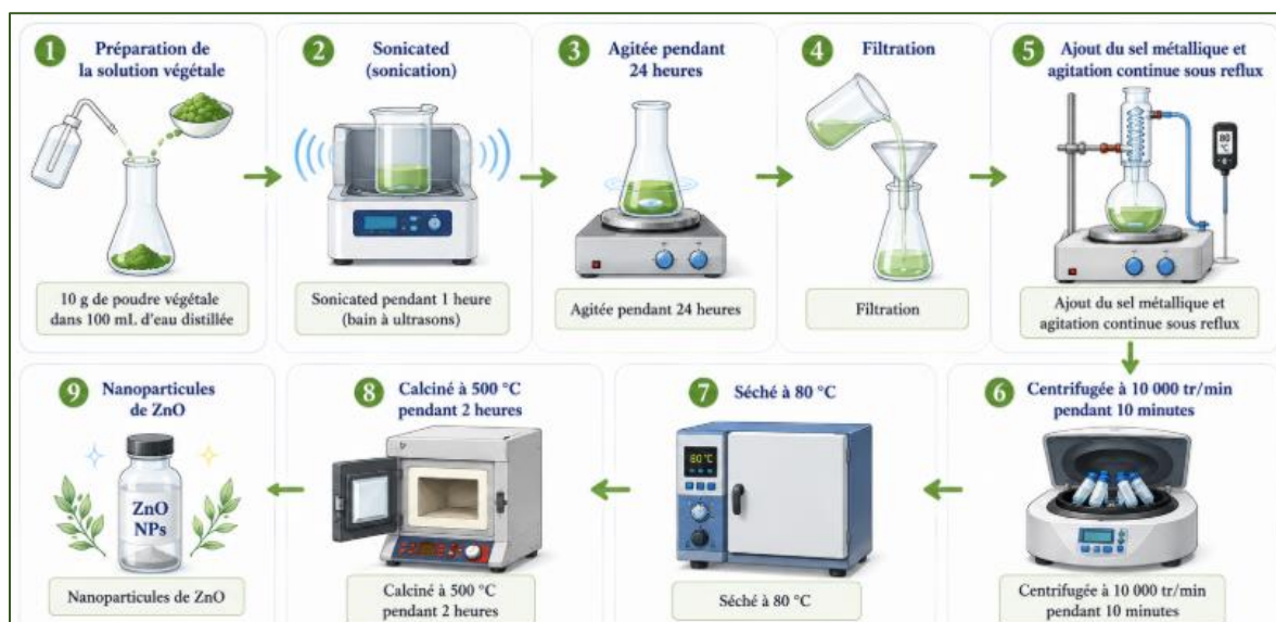
Figure 6. Représentation schématique du procédé de synthèse verte des nanoparticules de ZnO utilisant les extraits d' O. acaulon .
