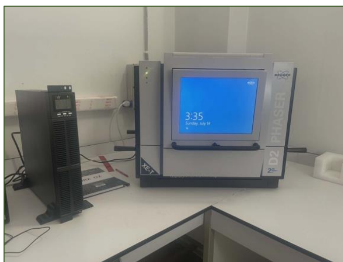
Figure 9. Diffractomètre à rayons X (Bruker D2 PHASER).
