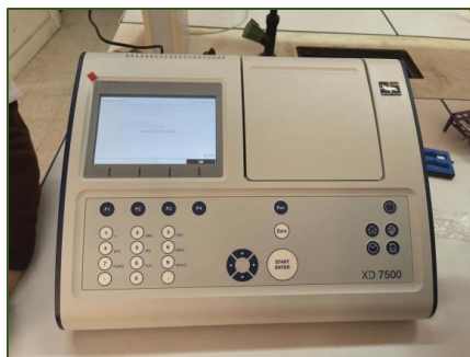
Figure 5. Spectrophotomètre UV-Visible (XD 7500) utilisé pour la détermination quantitative des phytochimiques.
