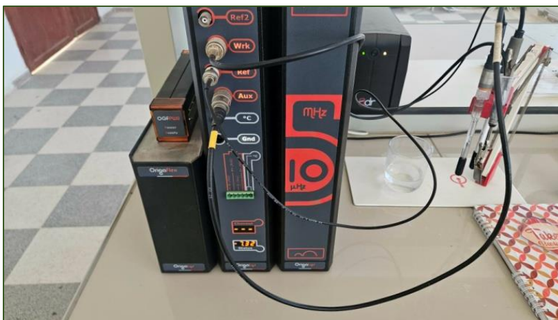
Figure 12. Montage expérimental du potentiostat (Origaflex 500) pour les analyses électrochimiques.
