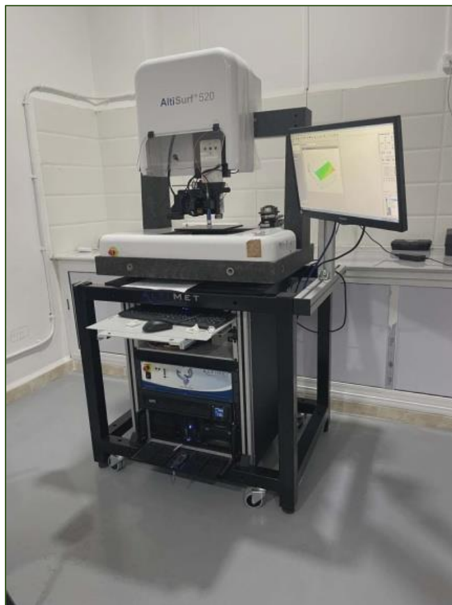
Figure 20. Profilomètre optique de surface AltiSurf 520.
