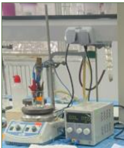
Figure 11. Montage électrochimique expérimental utilisé pour l'électrodéposition.
