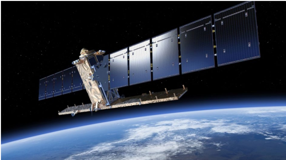
Figure 45 : Satellite SAR sentinel-1 utilisé dans la technique InSAR (ESA, ATG medialab).
