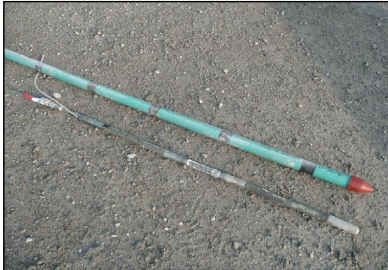
Figure 5.9. Tube à manchette/obturateur double (photo Solétanche-Bachy)
