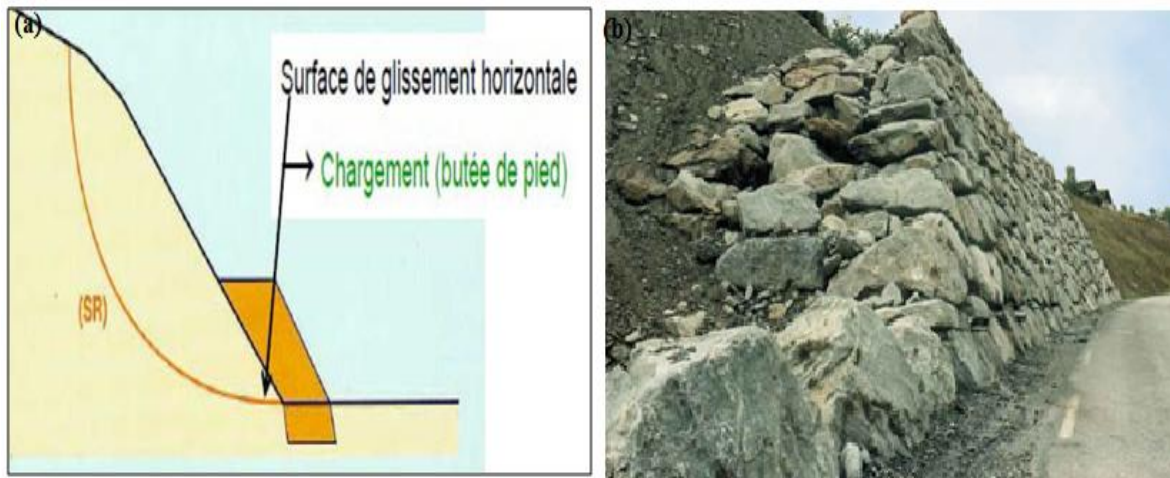
Figure 6.1. Le chargement en pieds (butée) Butée de pied en enrochement (Alpes-Maritimes)
