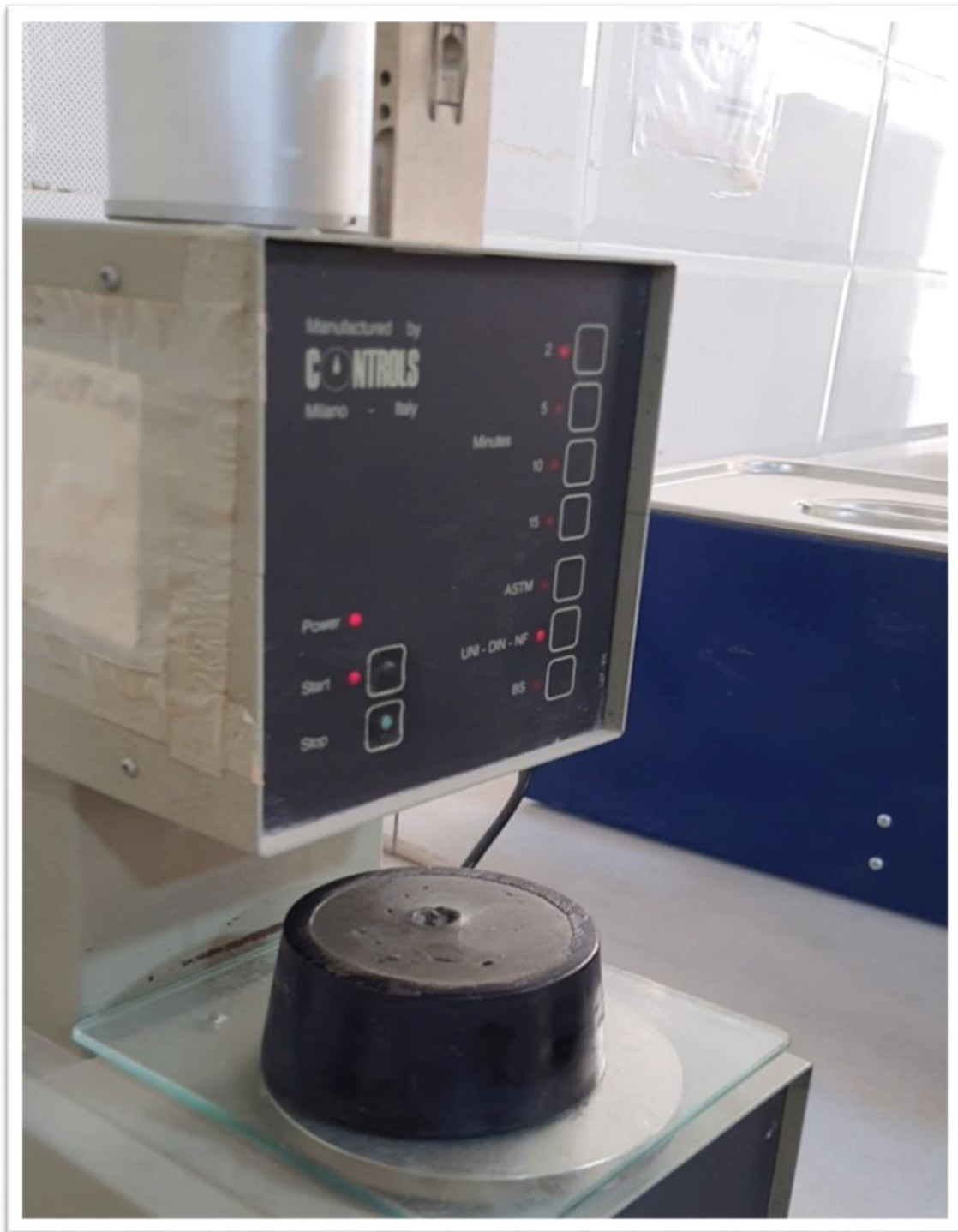
Figure 36:détermination du temps de prise de ciment
