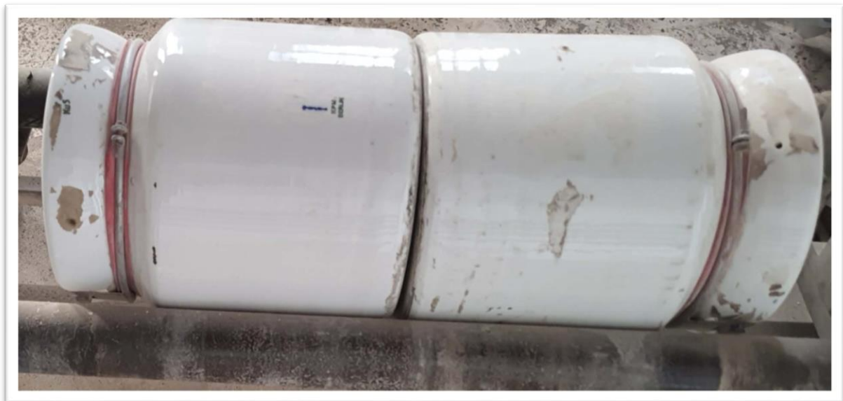
Figure 32 : broyeur à boulet de laboratoire
