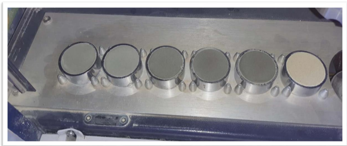
Figure 43:analyse chimique par fluorescence X
