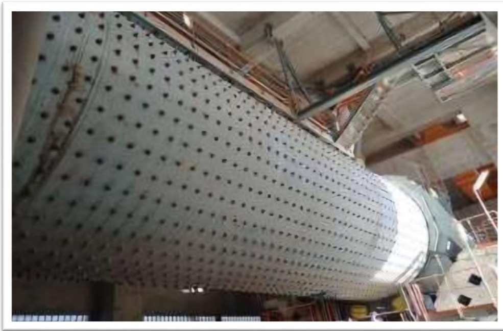
Figure 13 : broyeur à boulet type TIRAX UNIDAN
