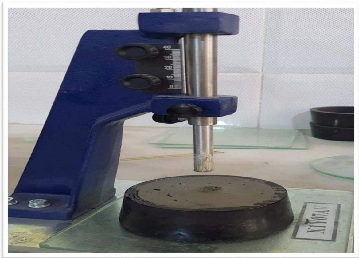
Figure 35 : vérification de la consistance normale du ciment
