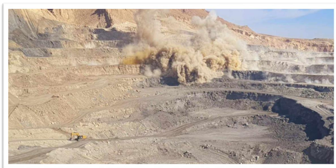
Figure 21: tir d'un gradin minier coté nord-ouest (27/11/2023 12:47)
