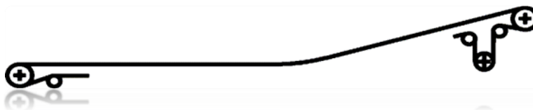
Figure II.17 Convoyeur à bande horizontale et tronçon incliné, où l'espace permet une courbe verticale et la charge ne nécessite qu'une seule bande.
