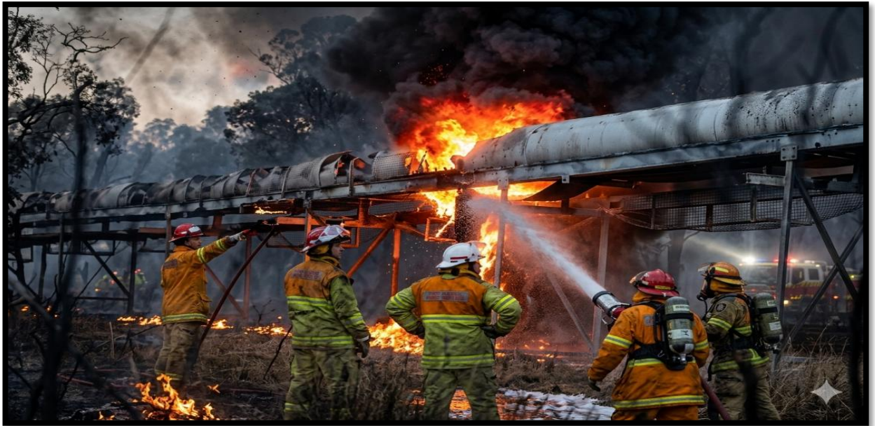
Figure III.19 : Risque d'incendie majeur et vulnérabilité structurelle d'une bande transporteuse conventionnelle.
