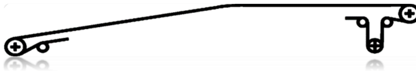
Figure II.19 Convoyeur à bande inclinée et tronçon horizontal, où la charge ne nécessite qu'une seule bande et l'espace permet une courbe verticale.
