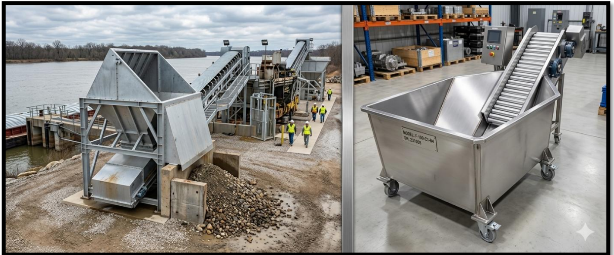
Figure II.11 : Vues de trémie de chargement.
