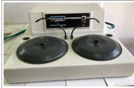
FIGURE 4.2 – Polisseuse mécanique de type BUEHLER METASERV utilisée pour la finition des échantillons.
