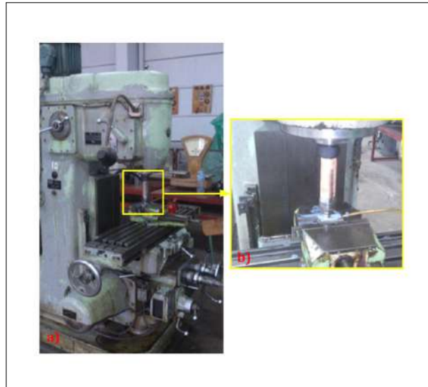
FIGURE 3.6 – Photo montage de l'outil de brunissage sur la fraiseuse a) fraiseuse verticale, b) photographie du dispositif [36]
