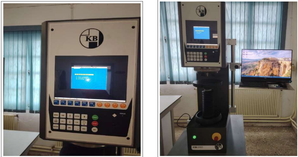
FIGURE 4.6 – Machine de dureté universelle type KB 250 (Laboratoire de l'Université Larbi Tébéssi, Tébéssa)
