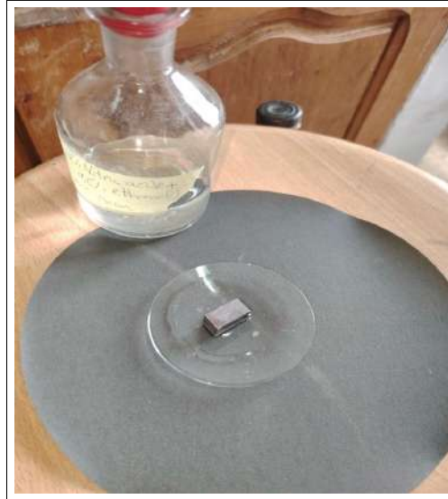
FIGURE 4.5 – Attaque chimique superficielle de l’acier X70 par le réactif Nital (3%).
