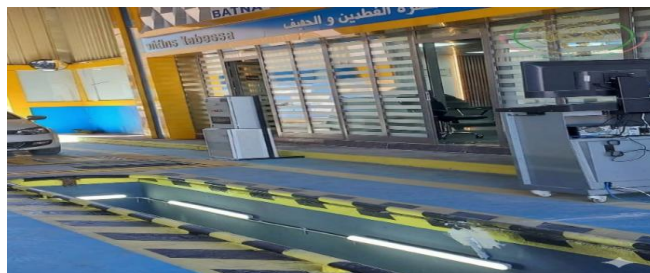
Figure 52: Fosse d'inspection équipée de bordures de sécurité et d'un système d'éclairage intégré pour l'expertise des organes inférieurs
