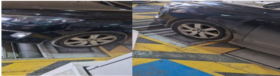
Figure 60: la roue avant est positionnée précisément sur la plaque vibrant du banc de suspension pour l'analyse des amortisseurs (Avant / Arrière)
