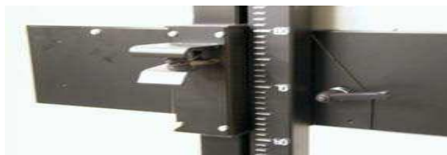
Figure 79: Dispositif de mesure de la hauteur de l'optique sur la colonne du réglo-phare
