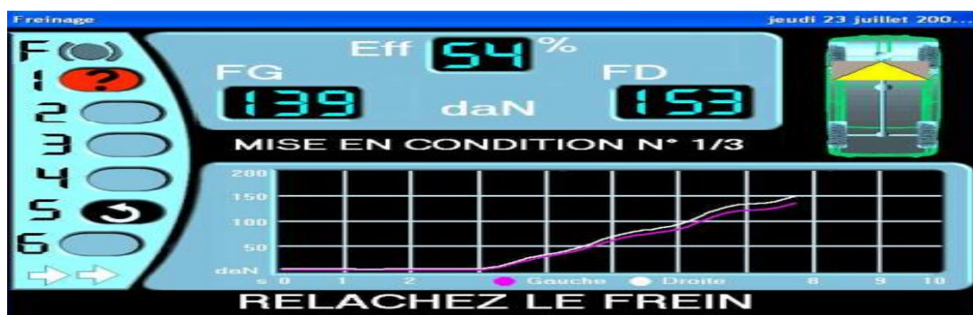
Figure 72: Ecran de mise en condition (1/3) affichant les forces initiales FG (139 daN) et FD (153 daN)
