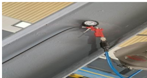
Figure 63: Manomètre de précision pour le contrôle et l'ajustement de la pression des pneumatiques
