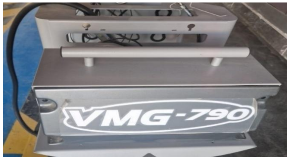
Figure 54: Analyseur de gaz de type VMAG-790 pour le contrôle de la pollution
