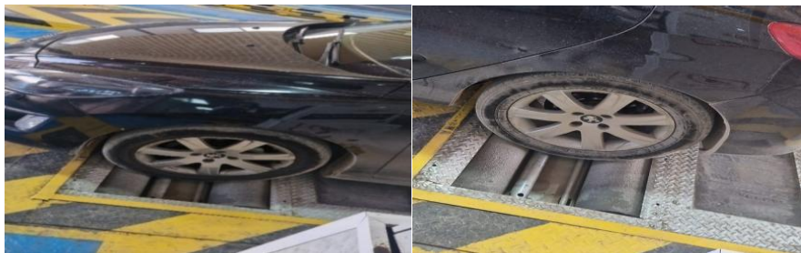
Figure 61: les roues logées entre les deux rouleaux motorisent qui vont opposer une résistance lors du freinage (Roue Avant /Arrière)
