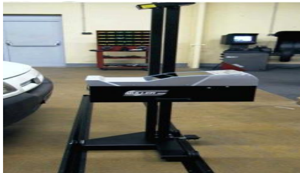
Figure 76: Positionnement au réglo-phare avant l'optique du véhicule
