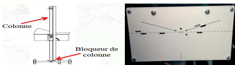
Figure 78: Schéma structurel du montant vertical et du bloqueur de colonne (a) - Ecran de visée gradue pour le contrôle de l'inclinaison et de l'asymétrie des feux (b)
