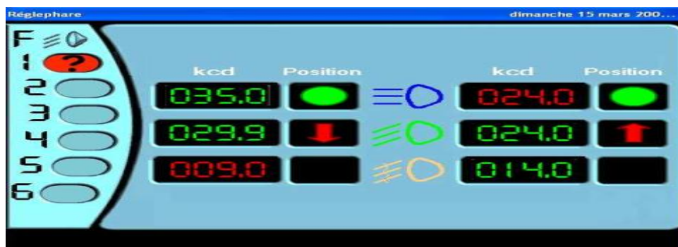
Figure 81 : Ecran de résultats du contrôle photométrique des différents feux
