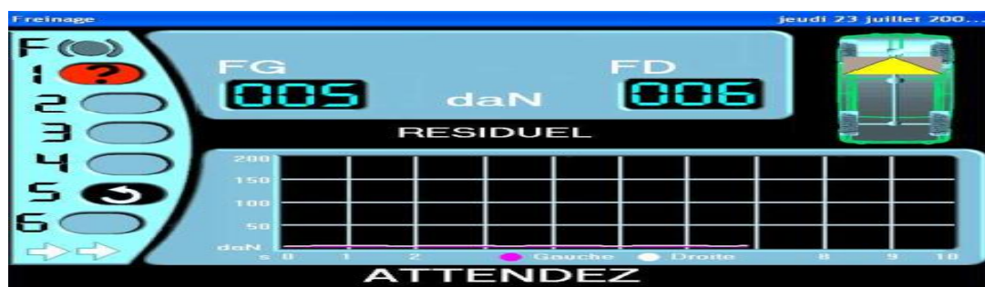
Figure 73: Mesure des forces résiduelles (faible valeur de 5 et 6 DaN)
