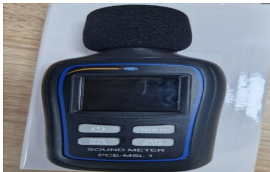
Figure 55: Sonomètre numérique PCE-MSL 1 pour la mesure du niveau sonore
