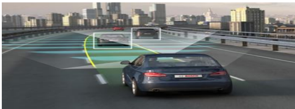
Figure 14: le système de régulateur de vitesse adaptif (ACC)
