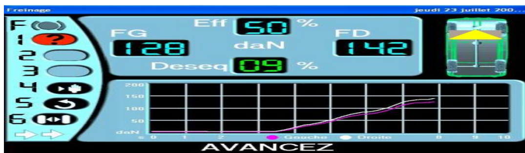
Figure 74: Résultat du test d'effort, le déséquilibre est de 9%, ce qui est excellent (inférieur à 20%)
