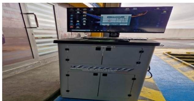
Figure 67: Unité de commande informatisée (Vmag) assurant le pilotage de la ligne et la réception des données de mesure
