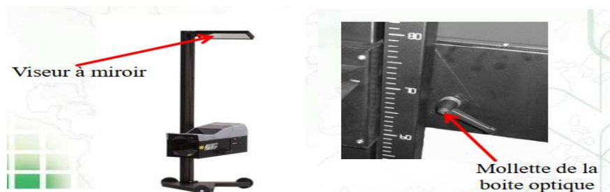
Figure 77: Positionnement du viseur à miroir pour l'alignement du réglo-phare (a)- Molette de blocage et graduation de la colonne du réglo-phare (b)
