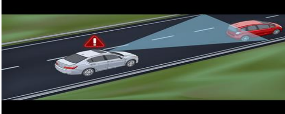
Figure 13: Le système d'alerte de vitesse excessive en virage (CSW)
