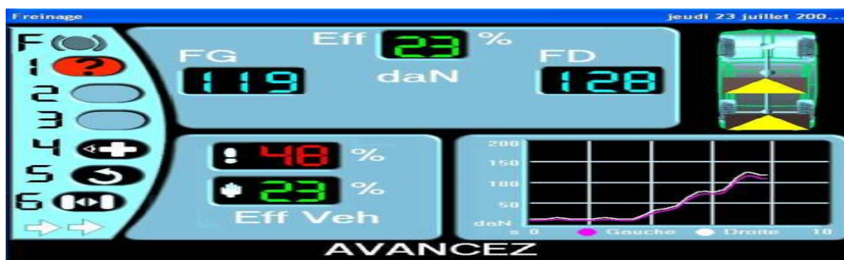
Figure 75: Bilan final affichant l'efficacité du frein de service (48%) et du frein de stationnement (23%)
