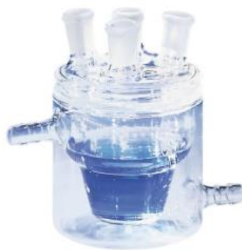
Figure 21. Schéma d'une cellule électrochimique.
