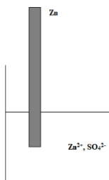
Figure 2. Représentation schématique de la demi-pile Zn^{2+}/Zn .
