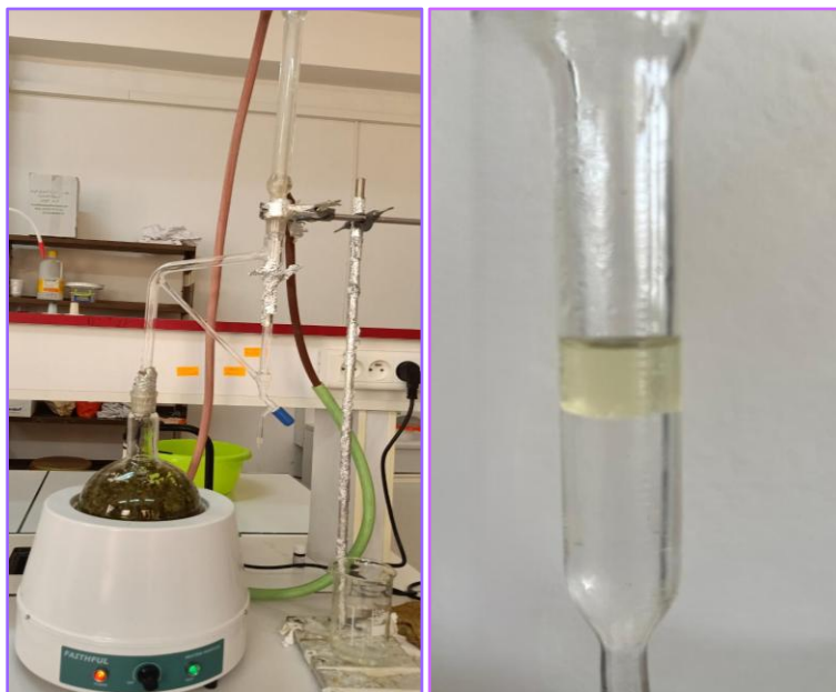
Figure 5. Extraction de l'huile essentielle par hydrodistillateur de type Clevenger.
