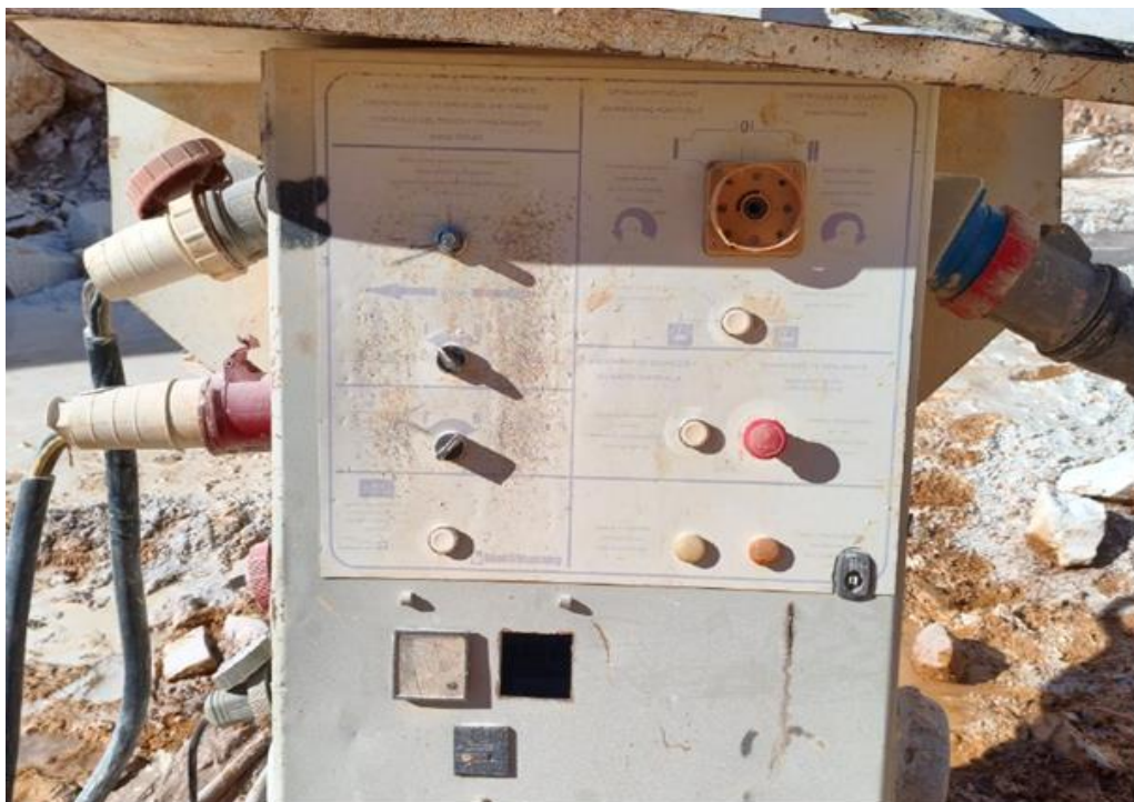
Figure 2.12 : Configuration générale du pupitre de commande déporté de la scieuse Gamma 875 (Cliché personnel, 12 février 2026).
