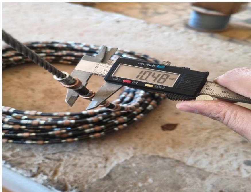
Figure 3.2 : Mesure du diamètre d'une perle (Cliché personnel, 25/02/2026).
