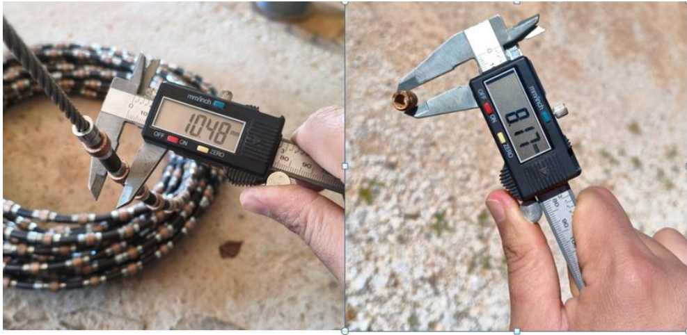
Figure 4.5 : Mesure au pied à coulisse numérique de l'évolution diamétrale d'une perle (neuve vs fin de vie).
