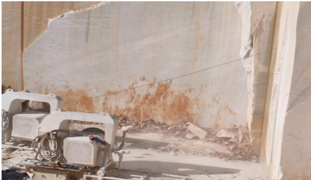
Figure 2.3 : Machine de découpe au fil diamanté (Modèle Gamma 875) en position sur le site d'exploitation – Unité de Filfila (Cliché personnel, février 2026).
