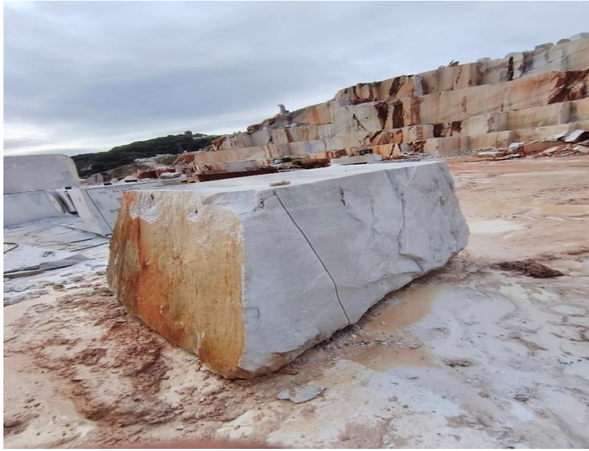
Figure 1.9 : Bloc monolithique de marbre blanc extrait par découpe au fil diamanté – Site de Filfila (Cliché personnel, 03 février 2026).
