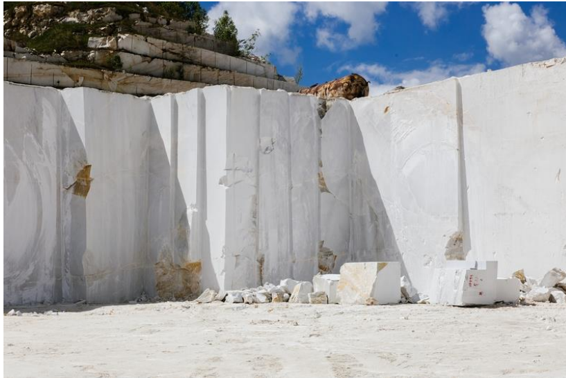
Figure 1.5 : Blocs de marbre marchands après extraction et équarrissage en carrière. [5]
