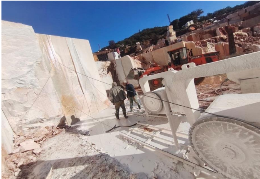
Figure 2.8 : Observation directe et supervision visuelle du processus de sciage par les opérateurs pour un réglage manuel basé sur l'expérience de terrain (Cliché personnel, 15 février 2026).
