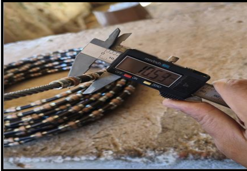
Figure 2.7 : Mesure métrologique du diamètre initial ( d=10,53 mm) d'une perle diamantée neuve à l'aide d'un pied à coulisse numérique de précision (Cliché personnel, février 2026).
