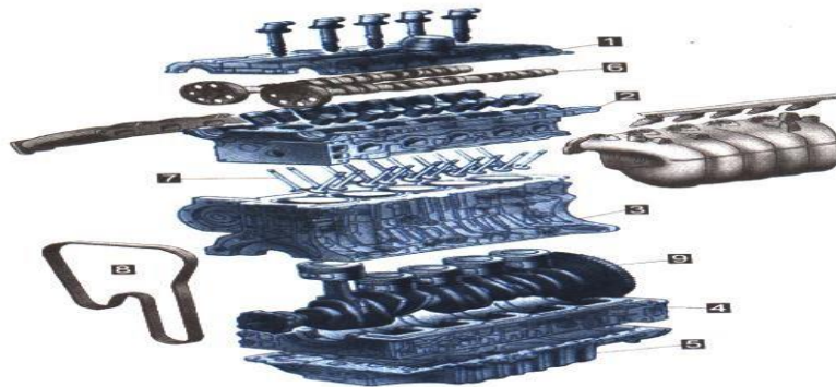
Fig6. Vue éclatée d'un moteur diesel [2].
