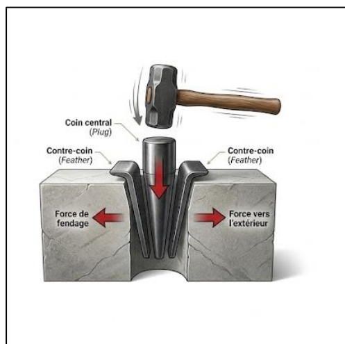
Figure 33 : L'utilisation de plug -and-plumes pour le fendage de la pierre
