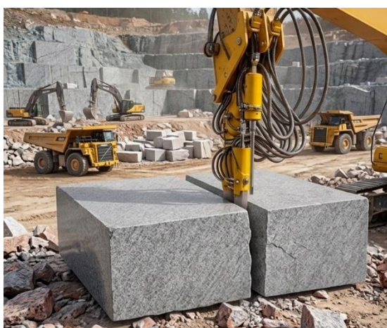
Figure 36 : Séparateur hydraulique de pierres et de roches
