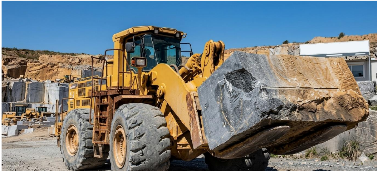
Figure 45 : chargement de blocs à l'aide d'une fourche sur un chargeur frontal (Rustenburg, RSA) (14)
