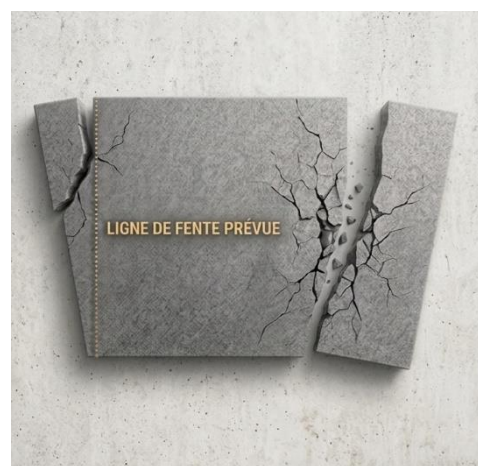
Figure 35 : Fente médiocre due à une application trop rapide de la force de fente
