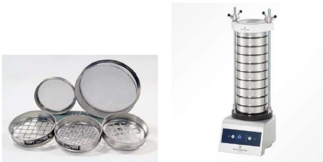
Figure 2.8 : Série de tamis avec une tamiseuse électronique.
