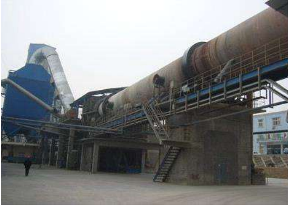
Figure 3.4 : Four rotatif pour la fabriquer de la chaux.
